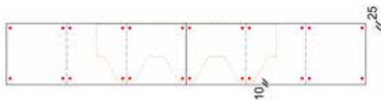
Рис. 12 Схема крепления коньково-карнизной черепицы Döcke PIE на карниз.
