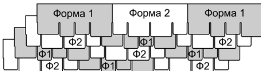
Рис. 15 Схема чередования гонтов гибкой черепицы Döcke PIE PREMIUM коллекции «Саппоро».
